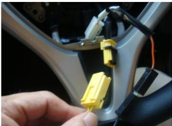
黄色のカプラー(エアバック電源線)を取り外します。
