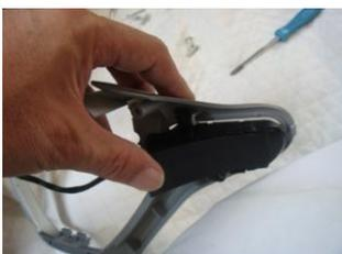
⑤Fit用 純正ステアリングリモコンスイッチをシルバーパネルの裏側からはめ込みます。
