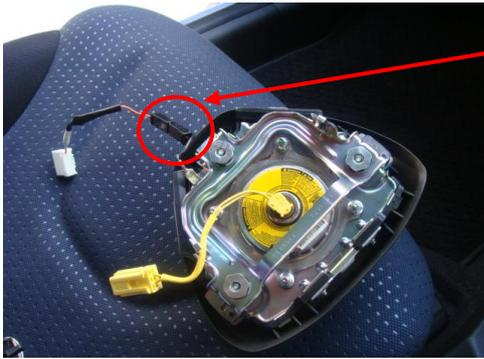
エアバックに固定されているアース線を中間の中継コネクタ部(黒コネクタ)で分割しておきます。
