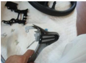
④リモコンスイッチ装着部の「目隠しパネル」部を取外します。
