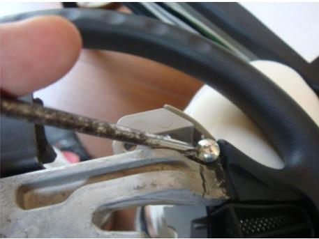
③リモコンスイッチ取付部の「目隠しパネル」を取り外すために、フロントパネル(シルバー色部)を取外します。
