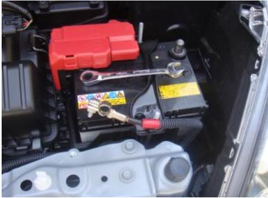
1. エアバックの破裂を防ぐ為に、まず、バッテリーのマイナス端子を外し、電源が流れないようにしてから、作業を開始します。
