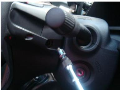
2. ハンドル横のネジ穴から、エアバック固定ボルトを外します。
