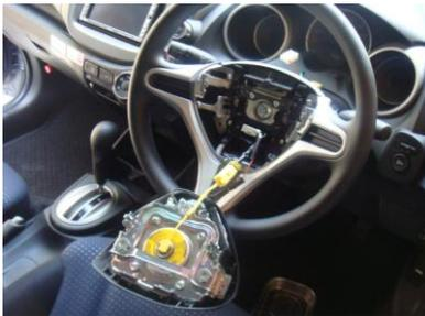
3. ボルト2本を取外すと、エアバックが左図の用に、取外せます。
