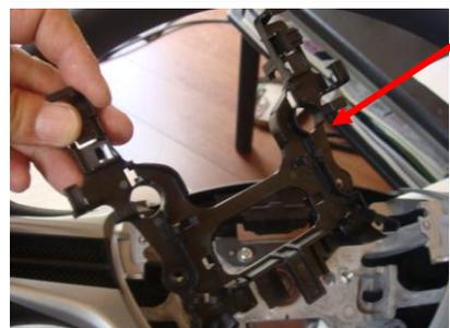
①まずハンドル内のセンターに位置する黒ブラケットを取外します。このブラケットが、ハンドル裏のパネルを固定しているので、必ず外します。
